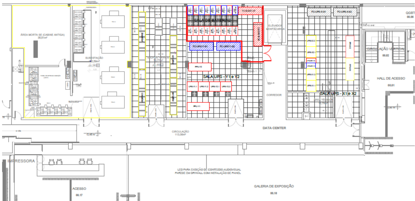
Figura 02: Leiaute da subestação e demais ambientes no térreo do DCRJ. (Equipamentos/ambientes novos, destacados em vermelho, equipamentos remanejados, destacados em azul e adequações gerais destacadas em amarelo).
